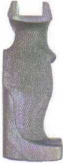
Arka yan gövde çok kalın El çatalı (solda)dar (sağda) çok geniş
